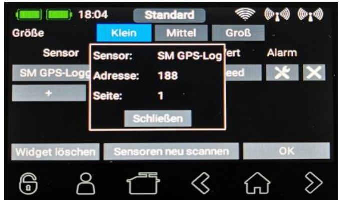
Ein langer Klick auf den Sensor im Widget zeigt auch die Adresse des Sensors. Diese kann mit X→Y auch geändert werden, um mehrere gleiche Sensoren anschließen zu können.
