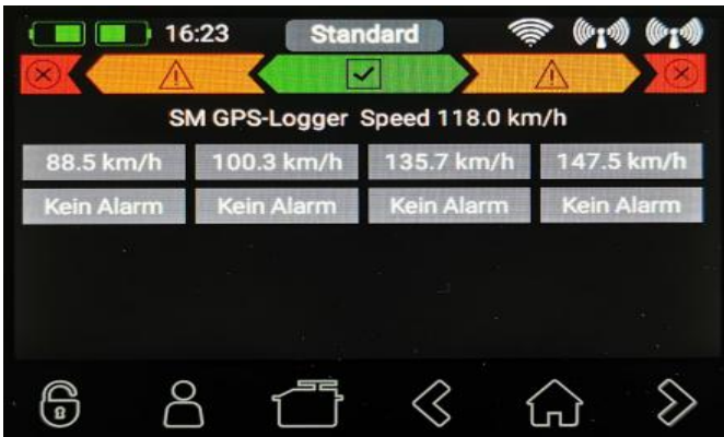
Alarmer werden direkt in diesem Widget im Sender definiert.
