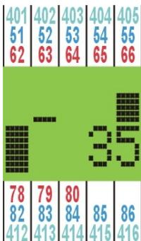
Der Ausschnitt zeigt einen Teil des Displays während dem Scannen mit einem 35 MHz Empfänger. Das Display hat zwei Zeilen mit je 16 Zeichen. Jedes Zeichen entspricht einem Kanal. Der jeweilige Kanal wird in der Spalte oberhalb bzw. unterhalb für das gewählte Frequenzband abgelesen.
