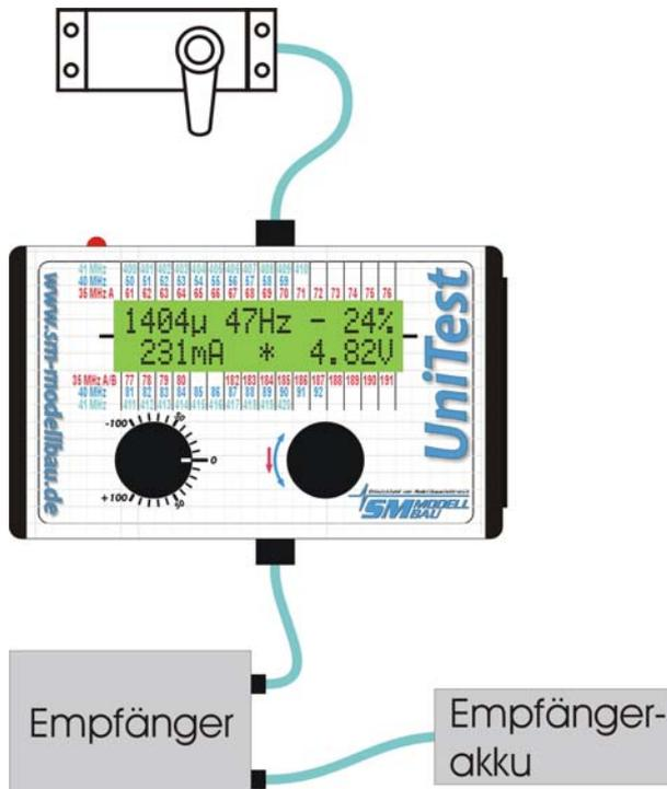
Die Abbildung zeigt den Anschluss aller Komponenten bei der Verwendung als Servoimpulsmessgerät.
