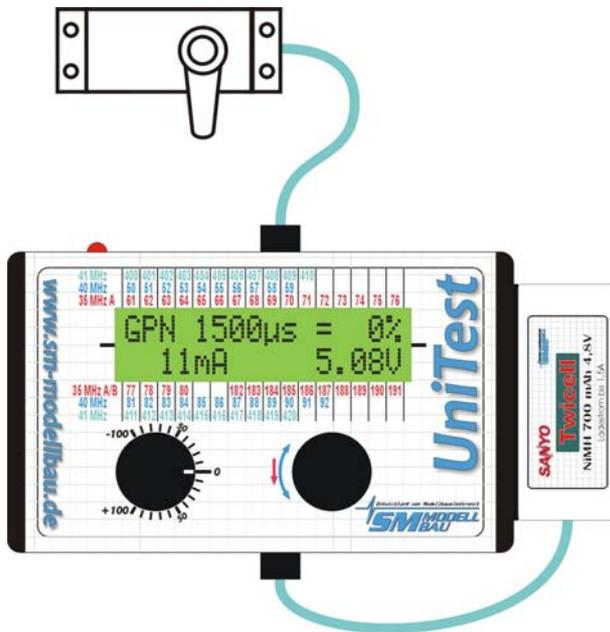
Die Abbildung zeigt den Anschluss aller Komponenten bei der Verwendung als Servotester.
