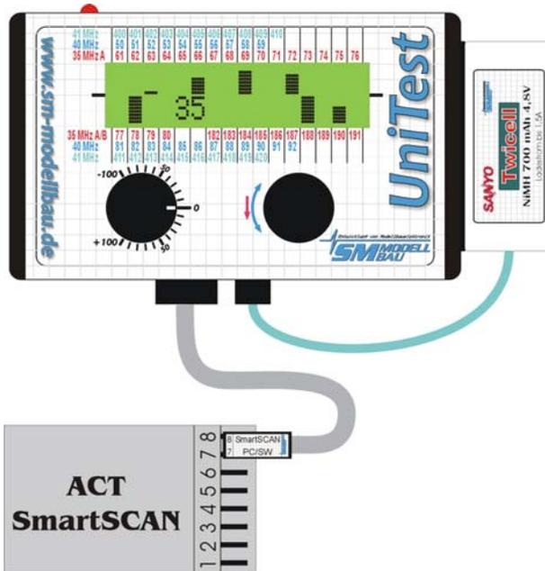
Die Abbildung zeigt den Anschluss aller Komponenten bei der Verwendung als Scanner.
