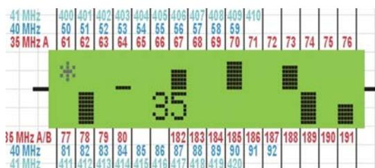
Beim aktuell überwachten Kanal blinkt ein \*. In diesem Fall, wie oben eingestellt, bei Kanal 61. Um einen anderen Kanal zu wählen oder die Überwachung abzuschalten muss wie vorher beschrieben der Menüpunkt 5 aufgerufen werden.
