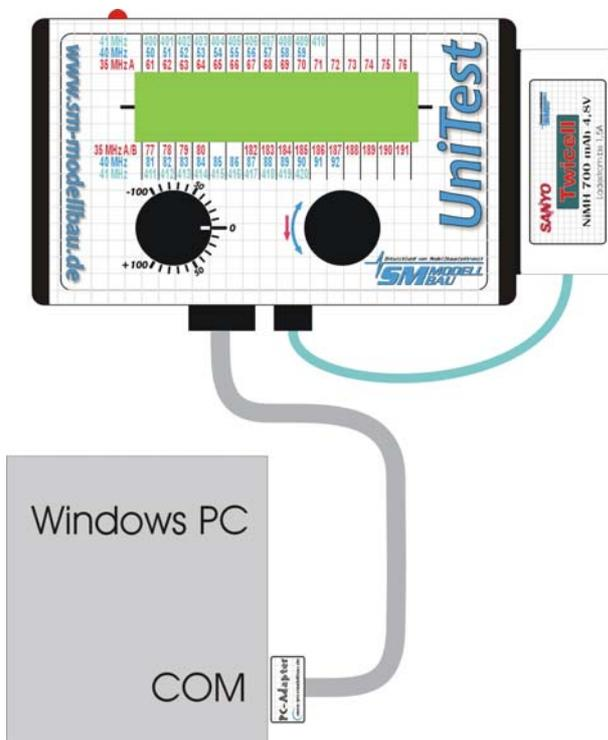
Am PC wird an einer freien seriellen Schnittstelle (COM) der PC-Adapter angeschlossen. Das andere Ende des Adapters wird beim **UniTest** an den Anschluss „Schnittstelle“ gesteckt. Das Adapterkabel wird vom **UniTest** aus mit Strom versorgt.
