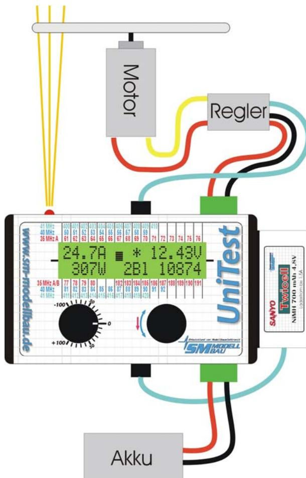
Nebenstehende Abbildung zeigt den Anschluss aller Komponenten bei der Antriebsmessung mit einem Regler ohne BEC.
